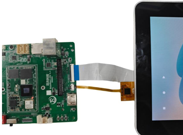
mipi 屏幕排线背面连接图
