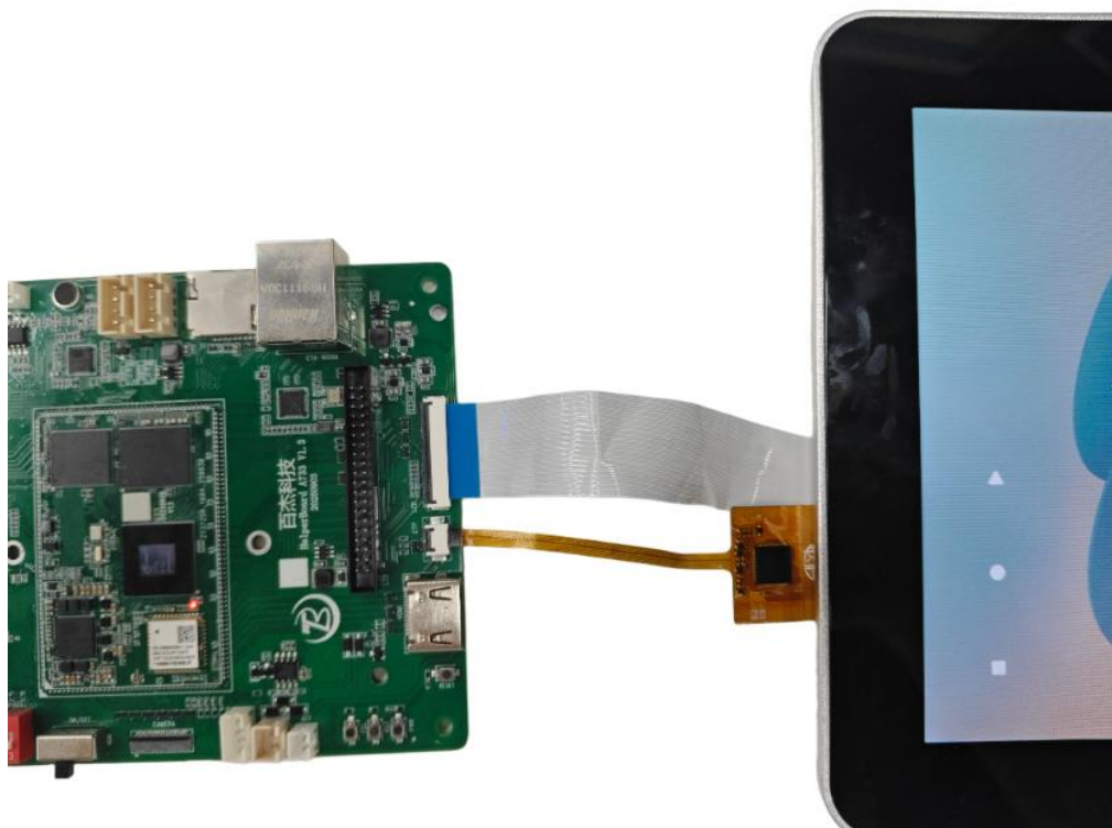
(2) mipi10.1 800x1280 和 mipi10.1 1200x1920 屏幕连接图
